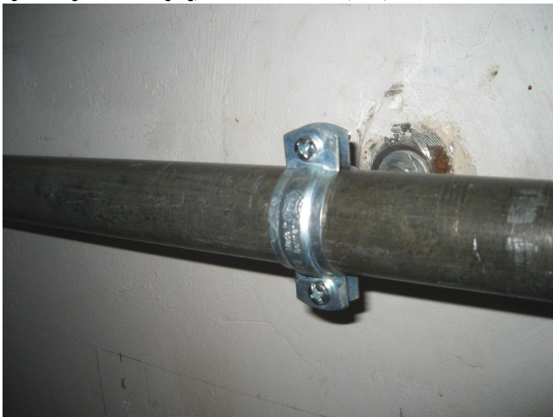
Bild 1: Bezugsmessung: starre Befestigung, Prüfrohr Durchmesser 33,7 mm, 1"
