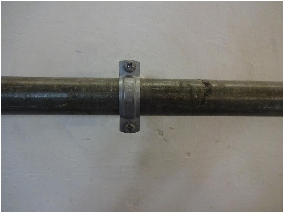
Bild 2: Bezugsmessung: Schraubrohrschele, 3/4" (25 - 30 mm), Anschluss M10, starrer Anschluss
