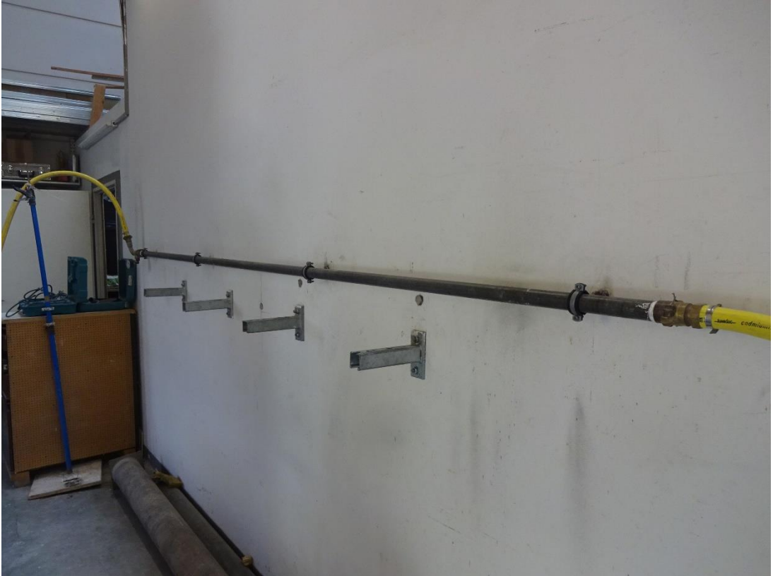
Bild 3: Schraubroherschelle mit DÄMMGULAST® schwarz, 1" (32 - 37 mm), M10, feuerverzinkt mit Schalldämmeinlage
