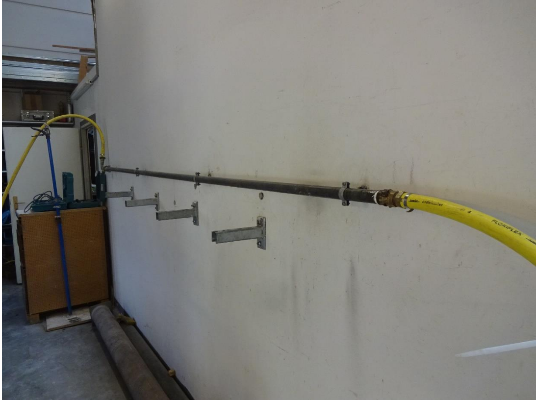
Bild 1: Bezugsmessung: Schraubrohrschele, 3/4" (25 - 30 mm), Anschluss M10, starrer Anschluss
