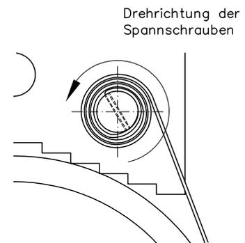
Stahlband um ungeschlitzte Schraube legen. Die Länge des kurzen Bandes muss einem Drittel des Rohrumfangs entsprechen, aber mindestens 100 mm betragen. Langes Stahlbandende auf Montagelänge schneiden und vorne zuspitzen. Die Montagelänge richtet sich nach dem Mastumfang.
