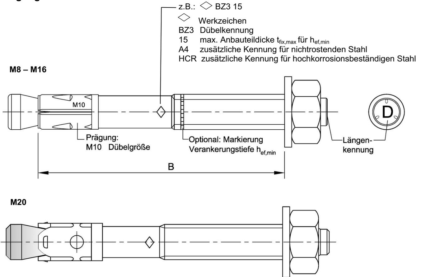
Nutzbare Länge:  $B = h_{ef} + t_{fix}$
