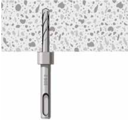
Bohren mit dem MPC-Bundbohrer.
